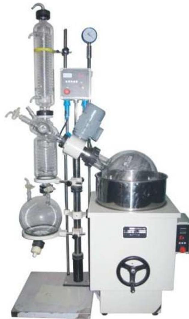
图25 旋转蒸发仪
