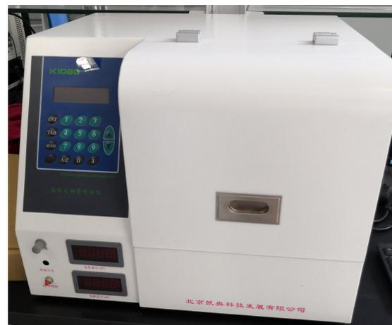
图12 高效毛细管电泳仪
